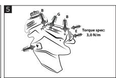
Place the Acerbis fuel tank (A) on the bike. Insert the tank (G), seat (B) and radiator scoops screws as indicated in the diagram. Montare il serbatoio Acerbis sulla moto. Riavvitare la vite (G), Riavvitare le viti (B) della sella e degli spoiler.
